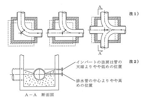
排水管が屈曲している場合 は、曲線をできるだけ緩くし て排水の自由な流化を図る。 そのために、ますの中心を斜 線の位置に設定することが望 ましい。
