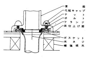
ウ 排水管が硬質塩化ビニル管 (樹脂フランジ) の場合の接着例
