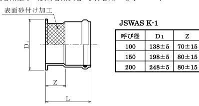
図 3-67 陶管ソケット部にビニル管を接合する場合
