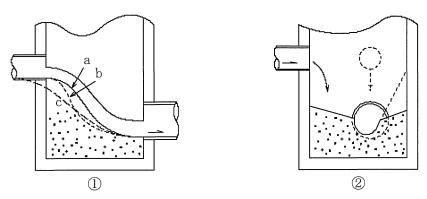
注) ②のようないわゆる滝落しは、排水を跳躍飛散させる。このため①の a, b のようなインバートで措置することが望ましい。 c は流入管の末端部に大曲管を使用したものである。ただし、インバートによって解決できない落差の場合は、ドロップますを設置する。
